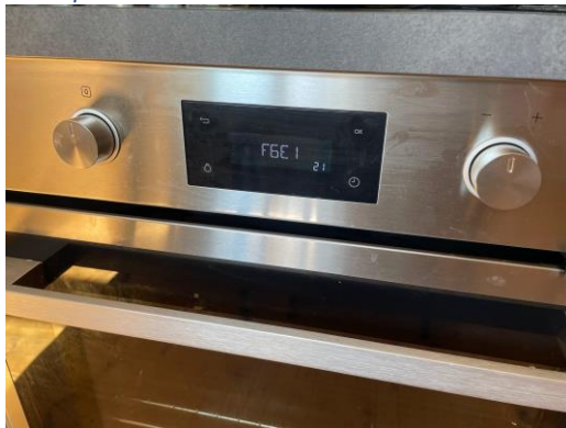
Figur 2 Efter elfel visar vänster ugn en felkod. Återställ ugnen genom att bryta strömmen genom propp 2 vid godiskiosken, under ca 5 sekunder.
